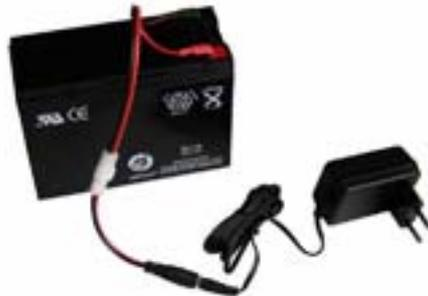
1. collegare il connettore bianco del filo della batteria al connettore bianco del caricatore da casa. Collegare il caricatore alla presa a muro. Si accenderà una luce rossa sul caricatore, quando la luce diventa verde la batteria sarà completamente ricaricata.
